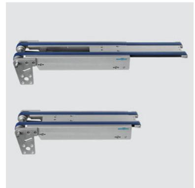
Das Entladetransportband SOLTB-E ist ein Doppelgurt-Förderband, das aus einem festen und einem ausfahrbaren Teil mit einem Hub von 160 mm besteht. Der ausfahrbare Teil wird mit einem pneumatischen Zylinder betrieben.
